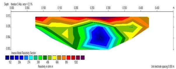
**Gambar 10.** Penampang resistivitas 2D penampang bawah permukaan untuk ( $R_c$  rencana = 85%)
