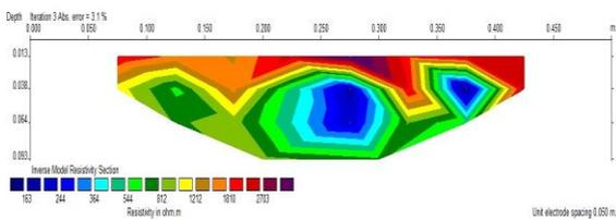
**Gambar 7.** Penampang resistivitas 2D penampang bawah permukaan untuk ( $R_c$  rencana = 85%)
