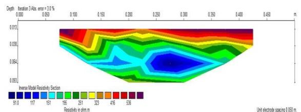
**Gambar 12.** Penampang resistivitas 2D penampang bawah permukaan untuk (Rc rencana = 75%)
