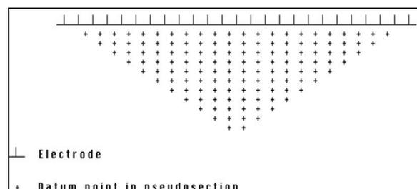
**Gambar 2.** Susunan elektrode dan urutan pengukuran data ERT konfigurasi *Schlumberger*.
