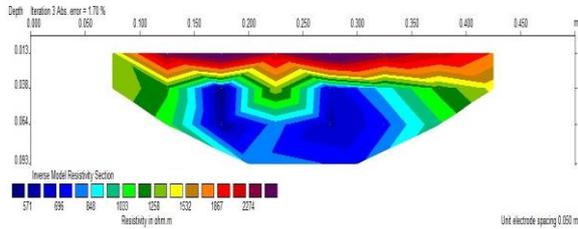
**Gambar 5.** Penampang resistivitas 2D penampang bawah permukaan untuk ( $R_c$  rencana = 65%)
