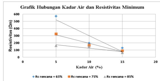
**Gambar 16.** Grafik hubungan antara nilai resistivitas minimum dengan kadar air tanah pasir
