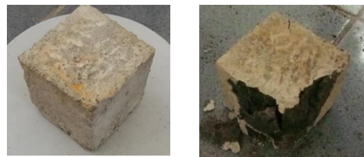
Gambar 2. Visualisasi benda uji sebelum dan sesudah pengujian kuat tekan
