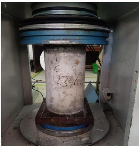
**Gambar 4.** Pengujian Kuat Tekan Beton
