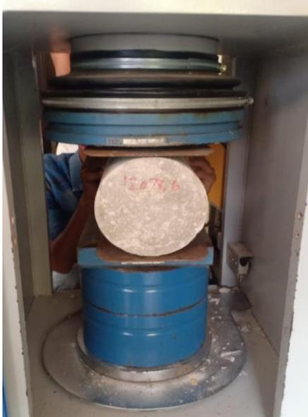
**Gambar 6.** Pengujian Kuat Tarik Belah Beton
