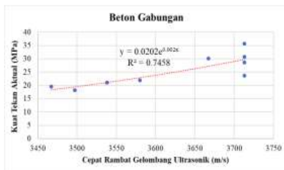
Gambar 8. Hubungan Kecepatan Gelombang dan Kuat Tekan Beton
