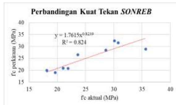
Gambar 9. Perbandingan Kuat Tekan menggunakan Formula SONREB Beton Usia 28 Hari
