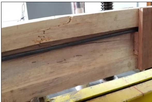
Gambar 9. Ragam kegagalan lentur benda uji 1 pada flange dan web
