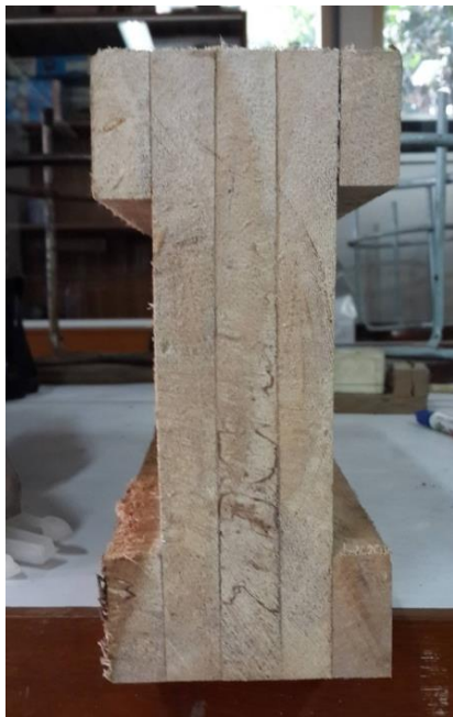
Gambar 2. Balok laminasi glulam profil I
