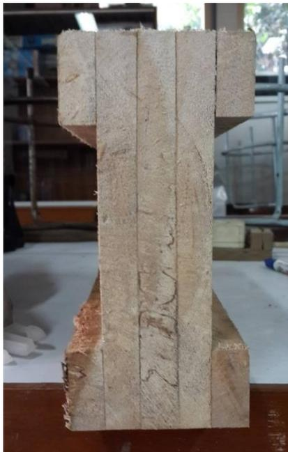
**Gambar 2.** Balok laminasi glulam profil I
