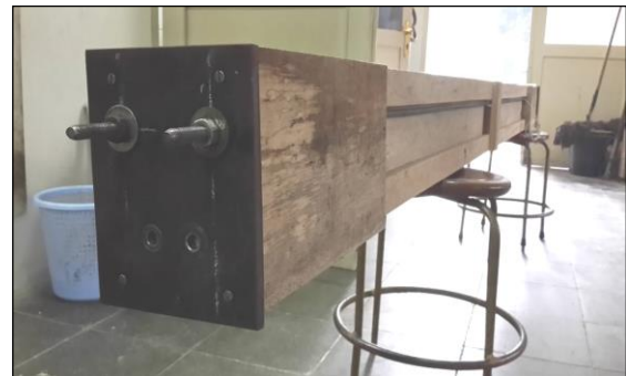
Gambar 3. Pemasangan tulangan pratekan pada balok kayu
