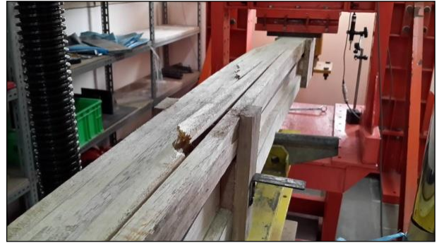
Gambar 10. Ragam kegagalan lentur benda uji 2
