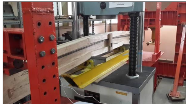
Gambar 11. Ragam kegagalan lentur benda uji 3
