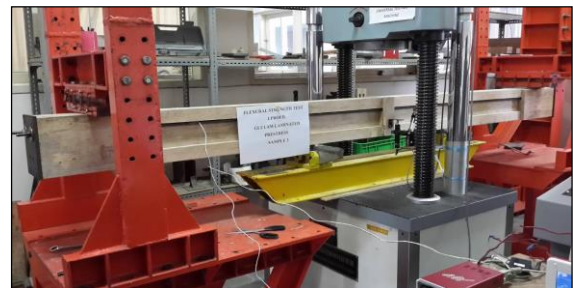
Gambar 5. Uji kuat lentur balok kayu benda uji 3
