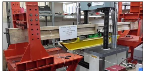
**Gambar 5.** Uji kuat lentur balok kayu benda uji 3
