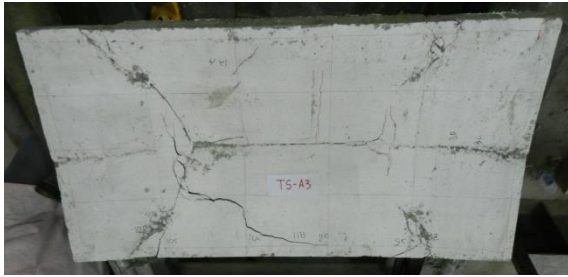
Gambar 12 Garis Leleh pada pelat akibat pengujian lentur dua arah
