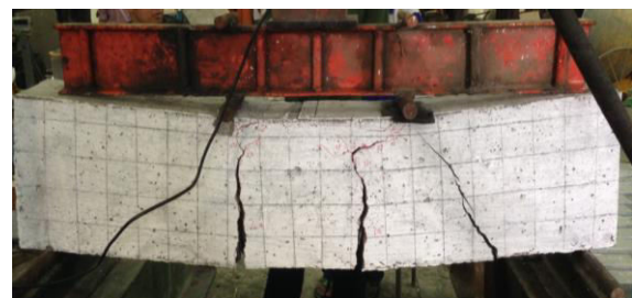
Gambar 9. Pola retak balok beton bertulangan bambu dengan kait jarak 10 cm
