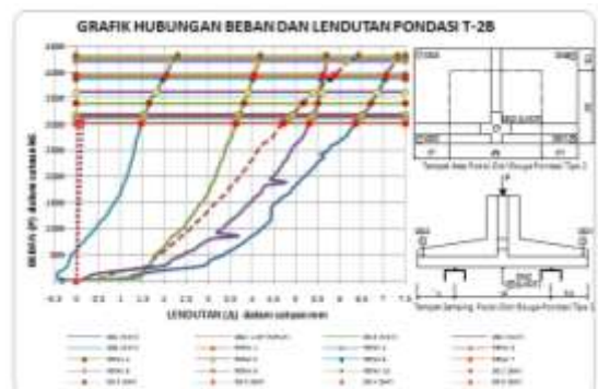
Gambar 13b. Hubungan Beban dan Lendutan Pondasi T-2B
