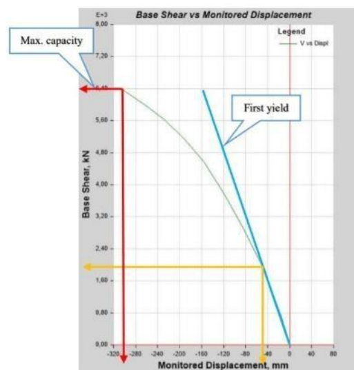
Fig. 3. Kurva kapasitas pushover arah Y
