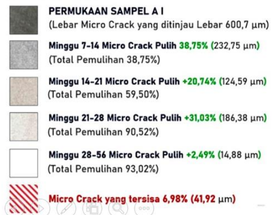
Gambar 8. Dimensi Pemulihan Micro Crack
