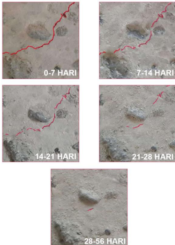
Gambar 9. Perubahan Pola Retak Sampel A I
