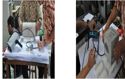
**Gambar 4.** UPV Test untuk benda uji silinder dan kubus
