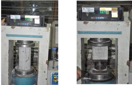
**Gambar 2.** Uji kuat tekan (compressive test) untuk benda uji silinder dan kubus
