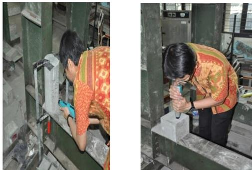
**Gambar 3.** Hammer Test untuk benda uji silinder dan kubus
